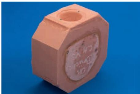
**Fig. 9:** La muffola ottagonale in SAE-M2 prima del preriscaldamento.
