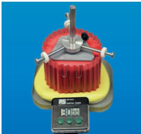
**Fig. 6+7:** La piastra di stabilizzazione è annegata nel silicone di duplicazione che ha la viscosità Shore 24. Il tempo necessario per l'indurimento del silicone è di 30 minuti. L'elevata viscosità garantisce la fedeltà del duplicato.
