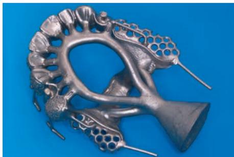
**Fig. 10:** La parte superiore della monofusione viene sabbata con corindone. Le aree interne vengono sabbate delicatamente con perle di vetro.
