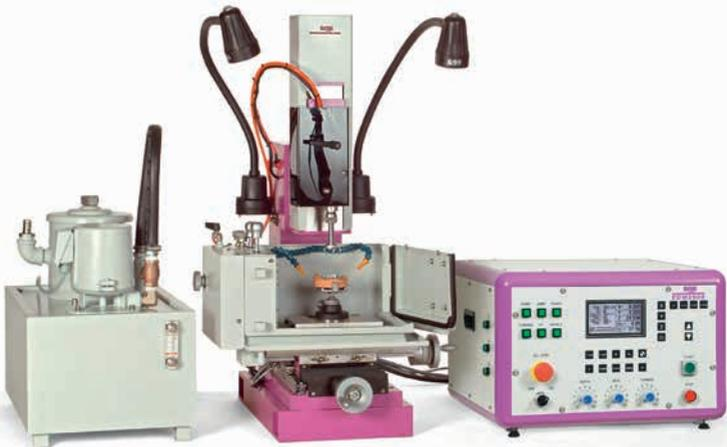
Fig. 12: La macchina per elettroerosione SAE tipo EDM 2000, anno di costruzione 2012
