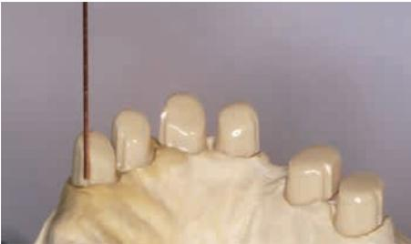
**Fig. 20:** Nella macchina per elettroerosione il modello con le corone primarie viene fissato al portamodello. La posizione dell'elettrodo abbassato e il consumo dell'elettrodo vengono fissati con il circuito memory.
