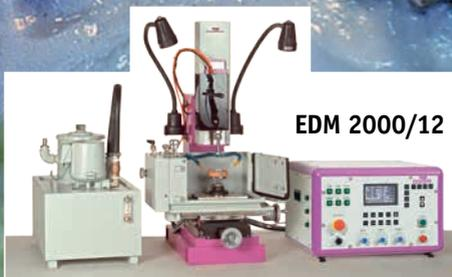
Macchina di elettroerosione
