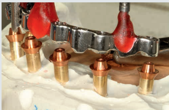
Il processo elettroerosivo SAE con gli elettrodi
