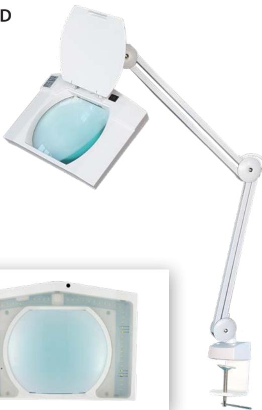
Lampada ad ingrandimenti che grazie all'ampia lente centrale di 18 cm da 3 diottrie permette di lavorare ad una distanza focale di 20 cm, assumendo così una posizione del lavoro estremamente ergonomica. I 56 leds disposti a corona sviluppano una luce molto chiara che illumina perfettamente il centro focale. La lampada è sostenuta da un braccio a molla che la bilancia e mantiene in posizione stabile. Fornita completa di coperchio protezione lente e morsetto da tavolo L003.
