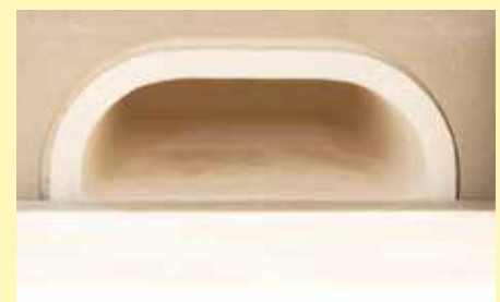
Muffola in ceramica a protezione degli elementi riscaldanti e dell'isolamento
