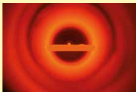
Fase di sinterizzazione con idrogeno in un forno tubolare della serie RHTH
