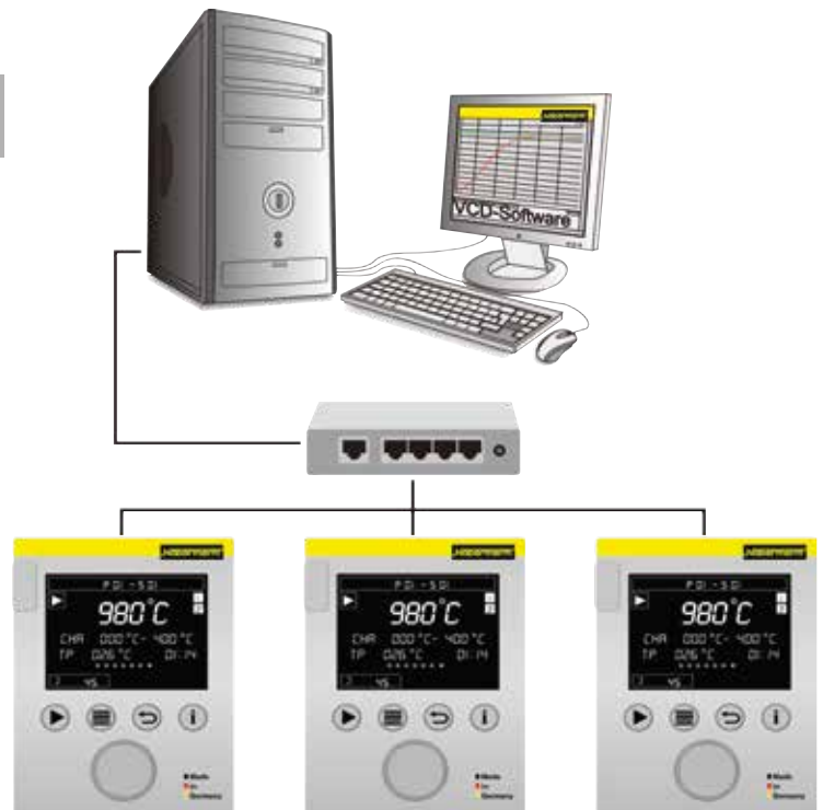
Esempio di configurazione con 3 forni
