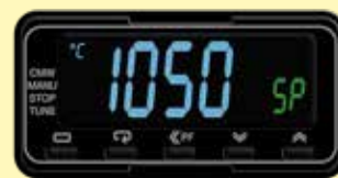
Esempio di selettore-limitatore della temperatura
