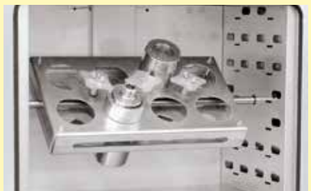
Dispositivo di rotazione elettrico (qui con piattaforma personalizzata per contenitori PARR)
