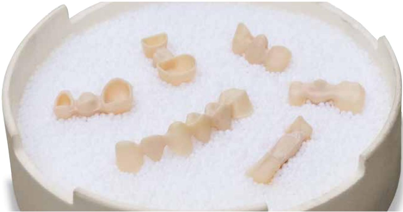
Contenitore di carica per forni di sinterizzazione LHT 01/17 LB Speed, LHTCT 01/16, LHTCT 03/16 e LHT 01/17 D
