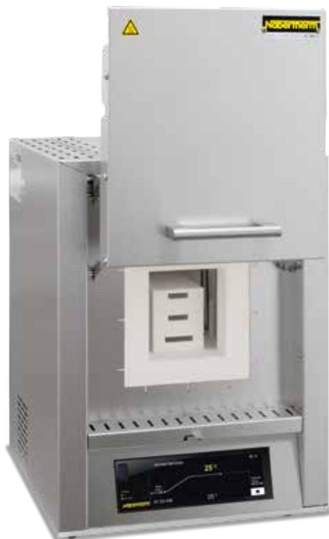
Forno di sinterizzazione ad alta temperatura LHT 01/17 D
