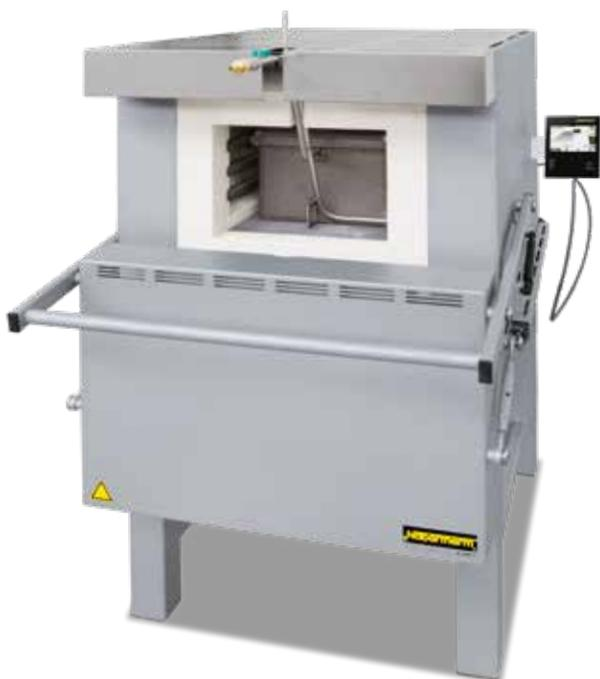
Sistema con forno a camera N 41/H con cassetta di gasaggio per gas protettivo
