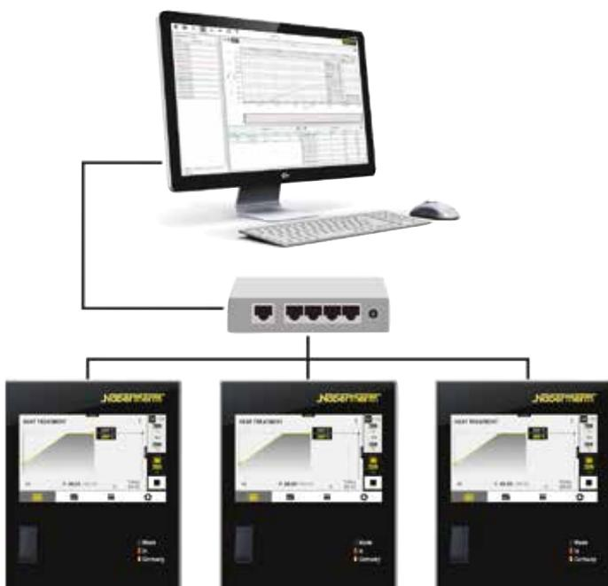
Esempio di configurazione con 3 forni
