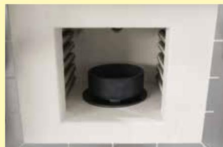
Caricamento nel forno di sinterizzazione LT 02/13 CR
