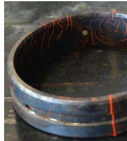
Rissanzeige sichtbar gemacht mit der Magnetpulversuspension Super Magna MEF 515 auf Wasserbasis
