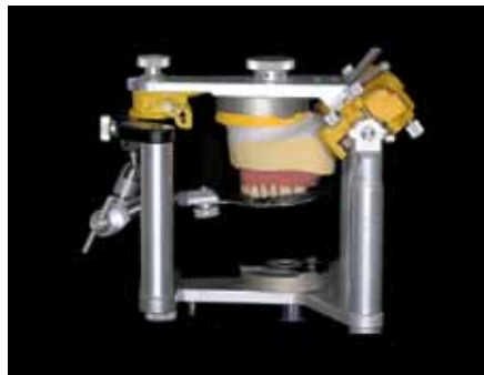
Fig. 9 Modello superiore montato rispetto al Piano di Francoforte
