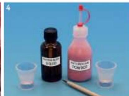
Il procedimento polvere / liquido con la resina da modellazione si presta in modo ottimale per unire i segmenti.
